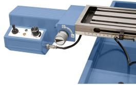
Stufenlos regelbarer Frästischvorschub
