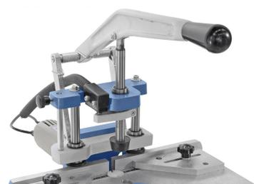
Funktionsweise: Beim Herunterdrücken des Hebels wird das Werkstück geklemmt und dann verfährt der Fräser bis zur voreingestellten Frästiefe. Beim Hochheben des Hebels in die Ausgangsposition wird das gefräste Werkstück f
