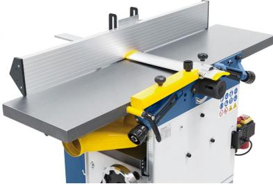
Der lange Abrichtanschlag gewährleistet durch seine große Auflagefläche eine präzise Bearbeitung von größeren Werkstücken.
