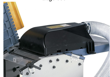
Kombinierte Späneauswurfhaube verwendbar zum Abrichten und Dickenhobeln.
