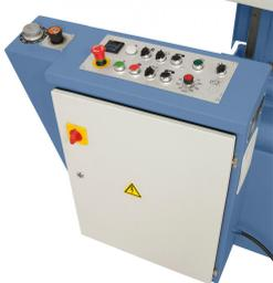
Übersichtlich aufgebauter Schaltkasten mit hochwertigen Elektrokomponenten
