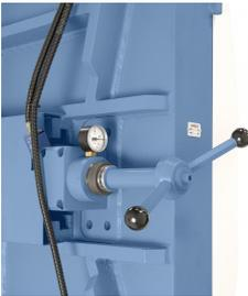
Mittels Manometer kann die Bandspannung optimal eingestellt werden, wodurch die Lebensdauer der Sägebänder erhöht wird.
