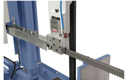
Die verschiebbare Sägebandführung kann optimal an die Werkstückbreite angepasst werden.
