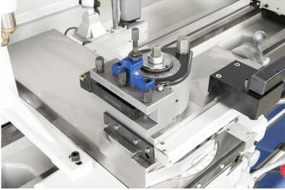
Zum rationellen Arbeiten kann die Maschine mit einem Schnellwechselstahlhalter ausgerüstet werden
