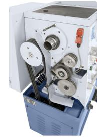
Serienmäßig ausgestattet mit Wechselräder zum Gewindeschneiden.
