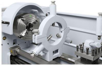
Feststehende Lünette zum Abstützen von langen und dünnen Werkstücken.
