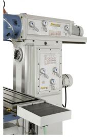
Logisch und übersichtlich aufgebaute Getriebschaltung für die Drehzahleinstellung
