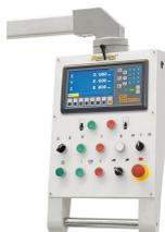
Übersichtlich aufgebautes Hängepaneel. Die Digitalanzeige ist serienmäßig im Lieferumfang enthalten
