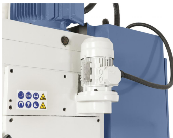
Vorschubmotor zur Reduzierung der Positionierzeiten der Pinole
