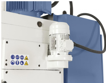
Vorschubmotor zur Reduzierung der Positionierzeiten der Pinole
