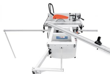
Der stufenlos schwenkbare (2 x 45°) Teleskopanschlag kann wahlweise vorne oder hinten am Auslegertisch montiert werden
