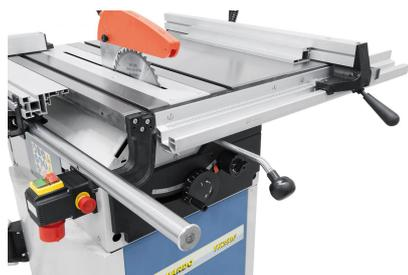
Zugkreisschneiden zum leichteren Bearbeiten von langen Werkstücken.
