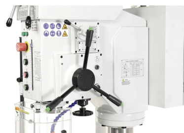
Serienmäßig mit 3-fachem automatischem Bohrvorschub ausgestattet
