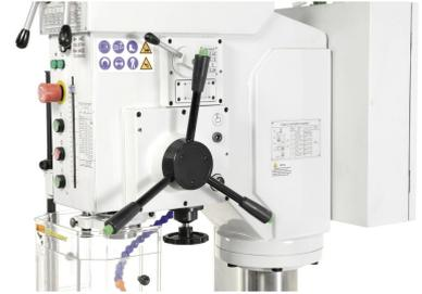
Serienmäßig mit 3-fachem automatischem Bohrvorschub ausgestattet
