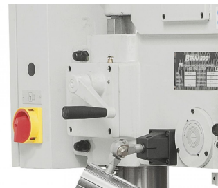
Einfache Höhenverstellung des Bohrkopfes mittels Kurbel.
