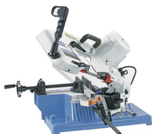
Der Sägebügel kann für Gehrungsschnitte bis 45° verstellt werden.
