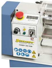
Elektronische, stufenlose Drehzahlregelung,
