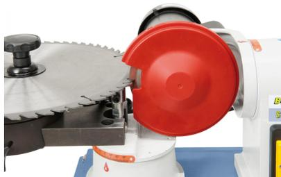
Geschlossene Schutzabdeckung nach CE-Norm für optimale Sicherheit.
