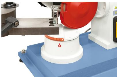
Verstellbarer Drehkranzwinkel zum Schärfe aller gängigen Sägeblätter.
