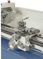
Für die Längs- und Querbewegung des Schlittens bzw. dem Obersupport stehen 6 frei wählbare Vorschübe zur Verfügung.
