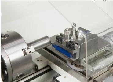
Zur Reduzierung der Nebenzeiten kann die Maschine mit einem Schnellwechselstahlhalter Bernardo Größe 20 ausgestattet werden.
