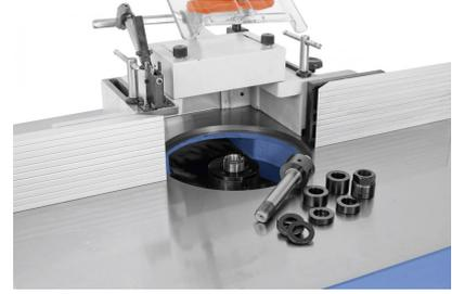
Durch die Wechselspindeln wird die Einstellung der Werkzeuge nicht verändert wodurch eine hohe Zeitersparnis bei Serienarbeiten erzielt wird.
