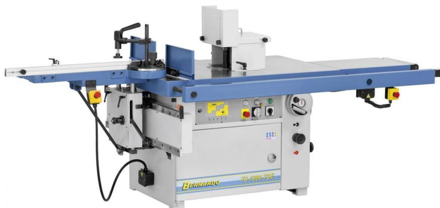
Die schwere Schwenkspindel-Fräsmaschine TS 1300 TCE ist durch den serienmäßigen Zapfenschneidisch für vielfältige Anwendungsmöglichkeiten geeignet. Ob Profilieren, Formfräsen, Zinkenfräsen oder Kopierfräsen, mit diesen beiden Modellen erzielen Sie immer beste Arbeitsergebnisse.
