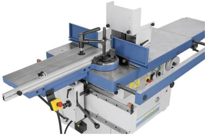
Abb. mit seitlichen Zapfenschneidschiebetisch, Teleskoplineal und Exzenterspanner. Zapfenschneidhaube für maximalen Werkzeugdurchmesser diam. 300 mm mit Tischverlängerung, Einlaufrolle und ausziehbarer Werkstückauflage an der Frontseite.
