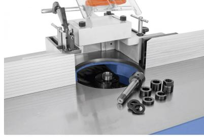
Durch die Wechselspindeln wird die Einstellung der Werkzeuge nicht verändert wodurch eine hohe Zeitersparnis bei Serienarbeiten erzielt wird.
