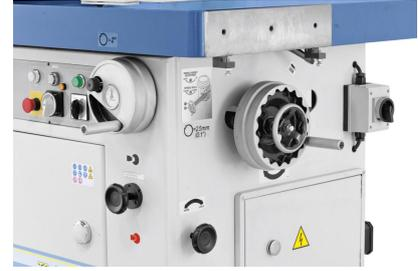
Präzise einstellbare Frässpindel durch großdimensionierte Handräder.
