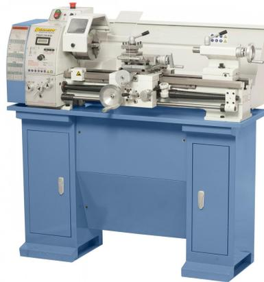
Die Vario-Drehmaschine Profi 700 BQV wird nach Werkzeugmachergenauigkeit gefertigt. Das Ablesen der elektronisch einstellbaren Drehzahl erfolgt komfortabel über eine Digitalanzeige am Getriebekopf. Die Besonderheit dieses Modells ist außerdem der große Längsvorschubbereich mit 14 frei wählbaren Vorschüben sowie der serienmäßige Planvorschub. Zur Reduzierung der Fertigungszeiten kann dieses Modell mit einer 2-Achs-Digitalanzeige geliefert werden.
