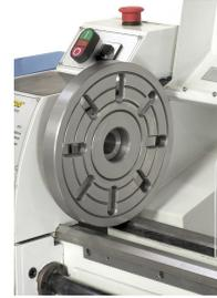
Zum Aufspannen von speziell geformten Werkstücken kann die Maschine mit einer 240 mm Aufspannscheibe ausgerüstet werden.
