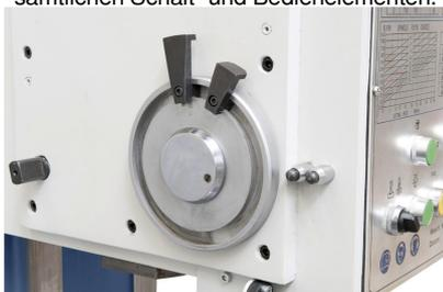
Gewindeschneideinrichtung mit Drehrichtungsumkehr, ideal für die
