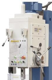
Übersichtlich aufgebauter Bohrkopf mit sämtlichen Schalt- und Bedienelementen.
