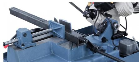
Einfache Verstellung des Schraubstockes
