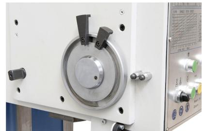
Gewindeschneideinrichtung mit Drehrichtungsumkehr, ideal für die Serienfertigung
