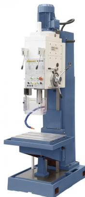
Die Kastenständerbohrmaschine KBM 50 ist für Bohr, Reib- und Gewindeschneidarbeiten sowohl in der Einzel-als auch in der Serienfertigung geeignet. Durch die massive Graugusskonstruktion kann dieses Modell für schwere Zerspanungsarbeiten in Maschinenbau, Produktion und Anlagenbau eingesetzt werden.
