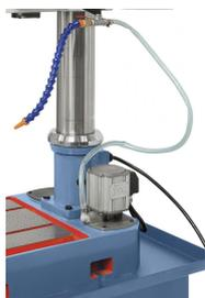
Handgeschabte Bodenplatte, serienmäßig mit integrierter Kühlmittelpumpe.
