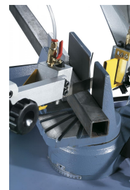
Der Sägebügel kann für Gehrungsschnitte von 90° bis 60° verstellt werden.
