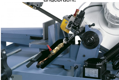
Für feinfühliges Absenken des Sägebügels serienmäßig mit Hydraulikzylinder
