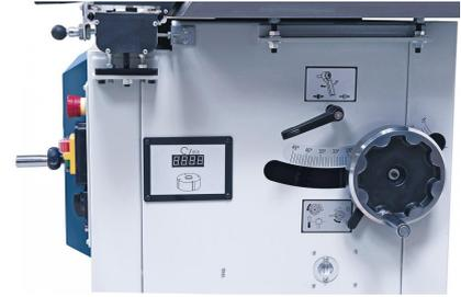
Elektronische Anzeige der eingestellten Fräsgeschwindigkeit.
