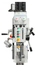
Übersichtlich angebrachte Schalt- und Bedienelemente an der Vorderseite der Maschine.
