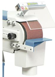
Hoher Schutz vor Funkenflug durch großdimensionierter Schutzscheibe
