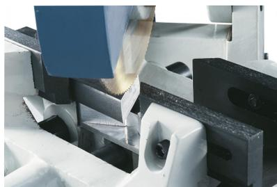
Schwenkbarer Getriebekopf (45° links / rechts), optimal für Gehrungsschnitte.
