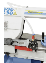
Kugelgelagerte Sägebandführung mit Schnellverstellung zum Anpassen an die Werkstückbreite garantiert ein optimales Arbeitsergebnis
