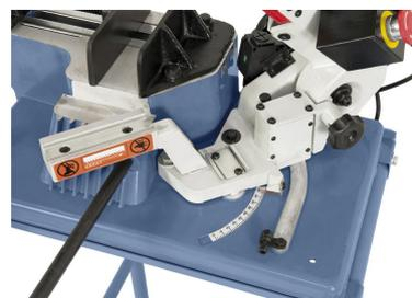
Verstellbarer Sägebügel zum Gehrungsschneiden
