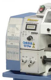
Elektronisch stufenlose Drehzahlregelung, leichtes Ablesen mittels Digitalanzeige
