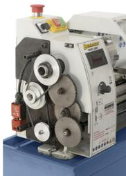
Serienmäßig ausgestattet mit Wechselräder zum Gewindeschneiden
