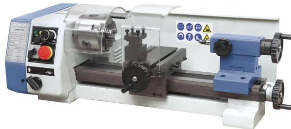
Die kleine und kompakte Tischdrehmaschine Hobby 250 ist aufgrund ihrer Präzision, sowie durch die Möglichkeit von Plan- bzw. Längsdrehen und Gewindeschneiden für den Bastler und Hobbyheimwerker bestens geeignet.
