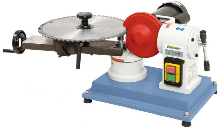
Die robuste Sägeblatt-Schärfmaschine SBS 700 dient zum Schärfen von hartmetallbestückten und CV-Sägeblättern mit einem Durchmesser von 80 - 700 mm. Durch die schwenkbare Motor-Schleifscheibeneinheit bzw. Sägeblatthalterung können die verschiedensten Verzahnungen geschliffen werden.
