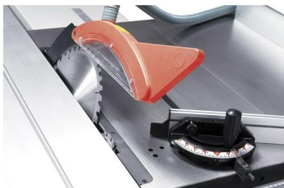
Das Sägeblatt kann für Winkelschnitte von 90° bis 45° geschwenkt werden, der Gehrungsanschlag ist für Schnitte bis 60° einsetzbar.
