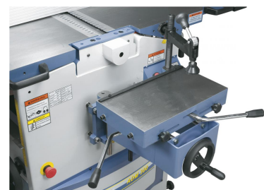
Die Langlochbohrereinrichtung ist ideal für Langlöcher, Dübel- und Schräglochbohrungen (optional)....
