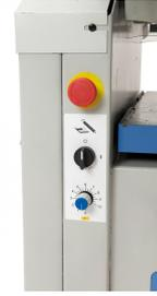
Stufenlos einstellbare Vorschubgeschwindigkeit, optimal für verschiedene Holzarten
