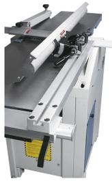
Sehr platzsparende Konstruktion durch den seitlich geführten Abrichtanschlag
