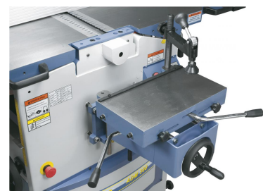
Die Langlochbohrereinrichtung ist ideal für Langlöcher, Dübel- und Schräglochbohrungen (optional)....
