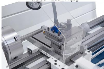
Der Schnellwechselstahlhalter Multifix
