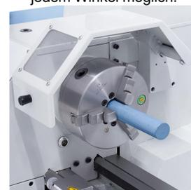
Zum Bearbeiten von großen Wellendurchmessern serienmäßig mit einer 38 mm Spindelbohrung ausgestattet.
