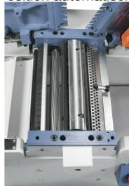
Durch die präzisionsgelagerte 4-Messerwelle
