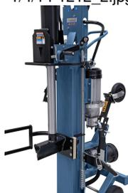
Großdimensionierter Spaltkeil mit stabiler, langlebiger Kunststoffführung.
