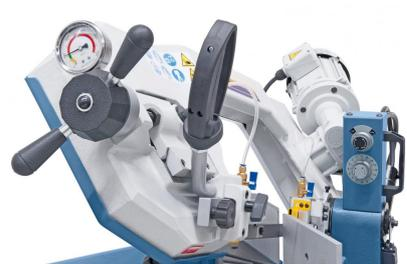
Stufenlos einstellbare Absenkung des Sägebügels mittels Regelventil.
