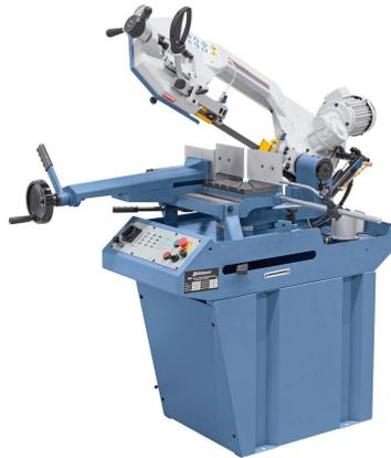
Das Modell MBS 280 DG PRO ist eine präzise Horizontalbandsäge für den universellen Einsatz. Die Merkmale dieser Maschine sind der schwenkbare Sägebügel für Doppelgehrungsschnitte von  $-45^\circ$  bis  $+60^\circ$ , sowie ein Hydraulikzylinder zum feinfühligem Absenken mittels Regelventil.
