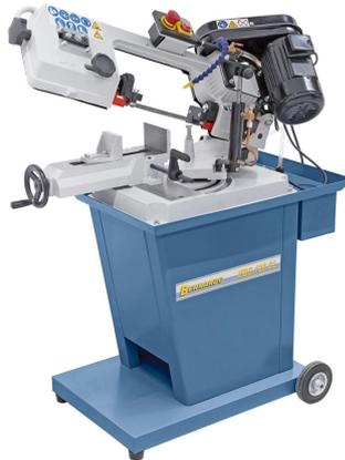
Die Doppelgehrungsbandsäge EBS 128 CL ist - im Vergleich zur bewährten EBS 128 C - serienmäßig mit einer Kühlmittleinrichtung ausgestattet. Der Sägebügel ist bis 60° schwenkbar, dadurch ermöglicht dieses Modell ein platzsparendes Arbeiten bei langen Werkstücken.
