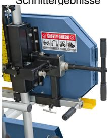
Bedienerfreundliche Sägebandspannung, leicht zugänglich
